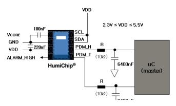
Figure 2.2: Typische Anwendungsschaltung (PDM)
